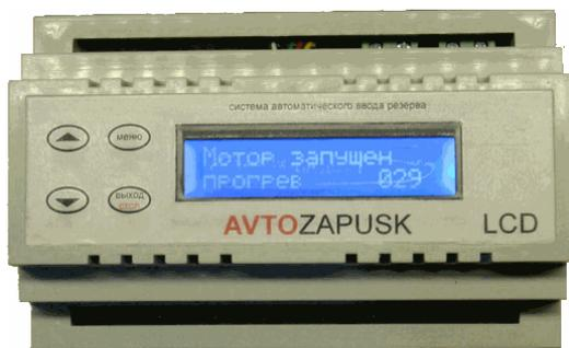
На передней панели контроллера расположены кнопки управления и дисплей для отображения текстовой информации . С обоих боков находятся клеммы («под болт») для подключения внешних электрических цепей.
